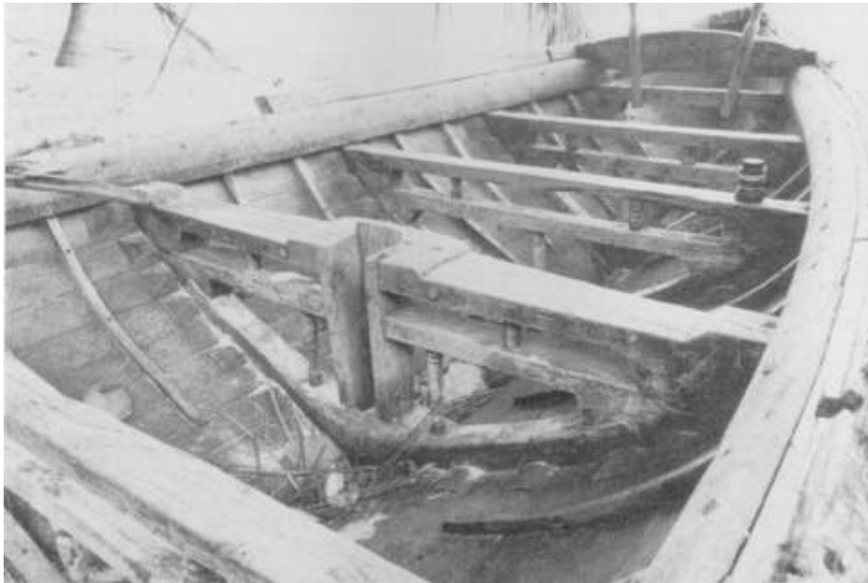
Photo 5. Ancien dhoni de petite taille à l'abandon : on distingue les rangées de blocs ( fothi ) réservés sur la face interne des bordés, les solides couples et baux qui leur sont associés (l'ensemble du premier plan est particulièrement épais, car il servait d'emplanture au mât), les petits demi-couples insérés entre les baux ; on distingue aussi les pièces de bois tourné ( haki ) qui relient les baux d'une même rangée entre eux
