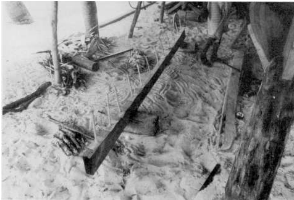
Photo 9. Préparation d'un bordé avec ses chevilles définitives : on distingue les morceaux d'écorce de noix de coco engagés autour de chacune d'elles
