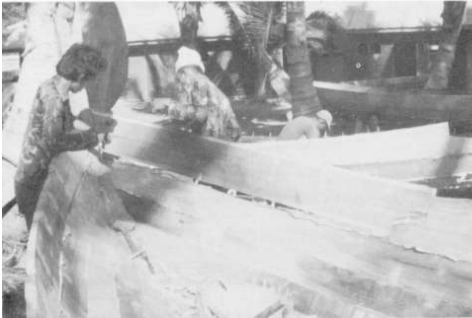
Photo 11. Processus d'assemblage de la coque d'un perahu pacaron à Pakisan (Java-Est) : le bordé est mis en place après plusieurs essais ; les chevilles sont définitives
