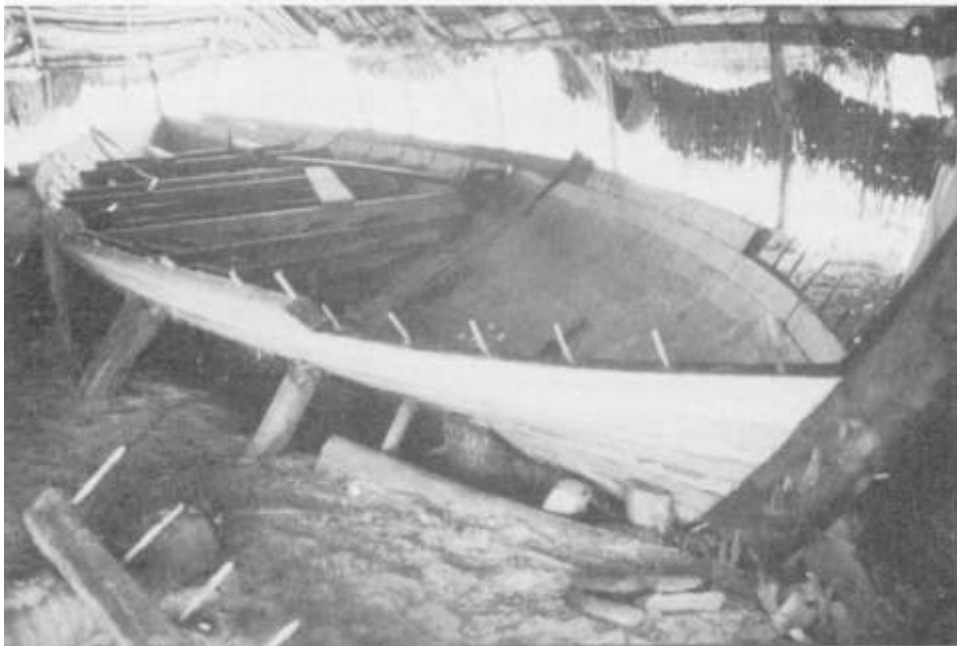
Photo 2. Grand dhoni en construction à Alifushi (construction sans blocs)
